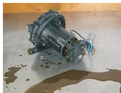
Condensa dei gas di scarico liquida da una pompa dell'aria secondaria
